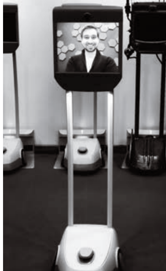
O empreendedor Marcos López experimenta a tecnologia da Beam, usada por gestores para estar “presentes” em unidades remotas; o usuário dirige o equipamento de seu computador
